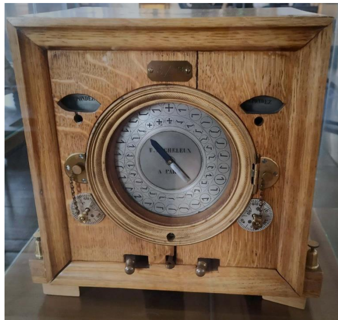
Récepteur de signaux Chappe Système Cacheaux, 1848
