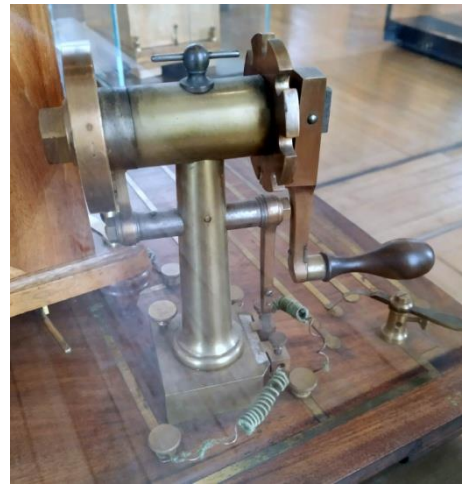
Récepteur télégraphique Foy-Breguet à deux indicateurs de signaux Chappe avec ses deux manipulateurs Construit par Breguet - 1844
