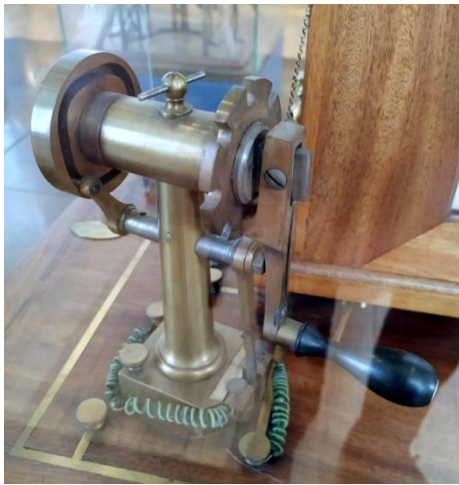
Récepteur télégraphique Foy-Breguet à deux indicateurs de signaux Chappe avec ses deux manipulateurs Construit par Breguet - 1844
